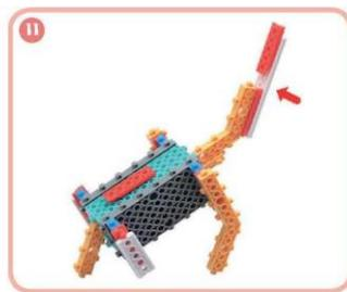
12. К крайнему соединительному блоку 3 крепим блок 11 и закрепляем конструкцию рамкой 11, сверху на неё прицепляем соединительный блок 3
